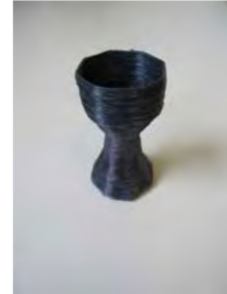
Labormuster aus PET-Garn gedruckt
