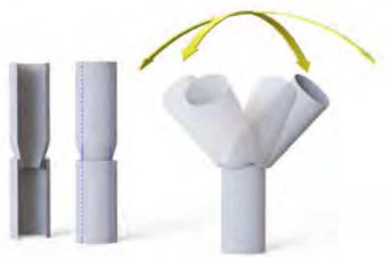
Aktiv verformbares 3D-FKV-Gelenk mit In-Situ-Aktoren
