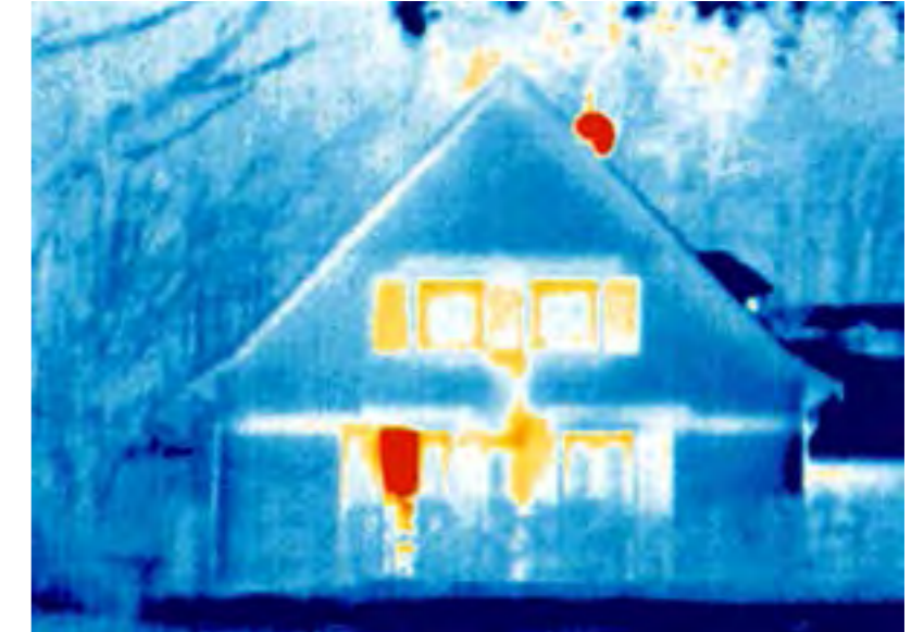
Typisches Gebäude mit erheblichem Energieeinsparpotenzial im Bereich der Fenster.
