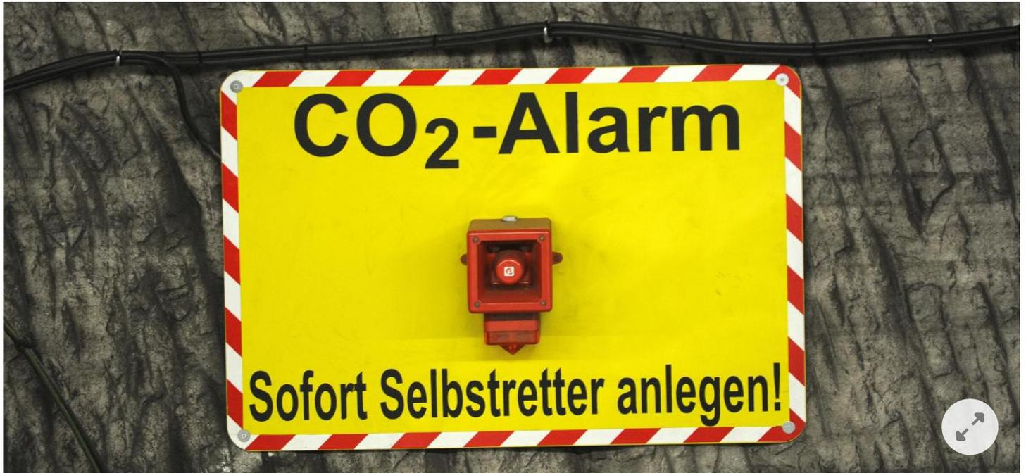
Warnschild für den Fall eines CO<sub>2</sub>-Alarms im Kaliwerk Werra. Ein als Selbstretter bezeichnetes Atemschutzgerät arbeitet mit chemisch gespeichertem Sauerstoff
